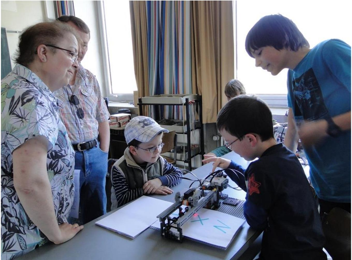
Der Scanner hat ein Einzugswerk (Rädchen), welches den Papiereinzug regelt. Gleichzeitig „liest“ der Lichtsensor die Helligkeitswerte der Buchstaben und speichert diese. Die Buchstaben werden dann am Desktop sichtbar oder können auch später groß am Bildschirm eines PC's ausgegeben werden.
